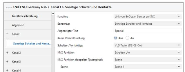
Dieses Profil unterstützt Taster mit kurzen/langen und doppelten Tastendruck. Zur Überwachung des Batteriestatus ist folgendes Objekt verfügbar:
