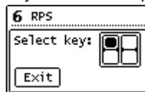
Hier kann man mit dem Taster T2 der Druckpunkt (oben oder unten) des Lern-telegramms ausgewählt werden. Bei manchen Aktoren müssen mehrere Druckpunkte getrennt eingelernt werden.
