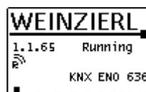
Die Repeater-Funktion des STC-KNX wird über die allgemeinen Parameter in der ETS aktiviert. Ist die Funktion aktiv, wird dies im Hauptmenü des Displays links unter der individuellen Adresse angezeigt.
